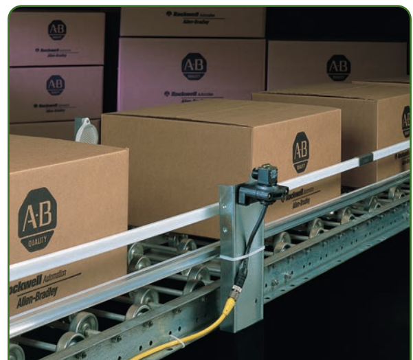
Aplicación de manejo de materiales - Un RightSight retrorreflexivo detectando paquetes en una línea de transportador.
