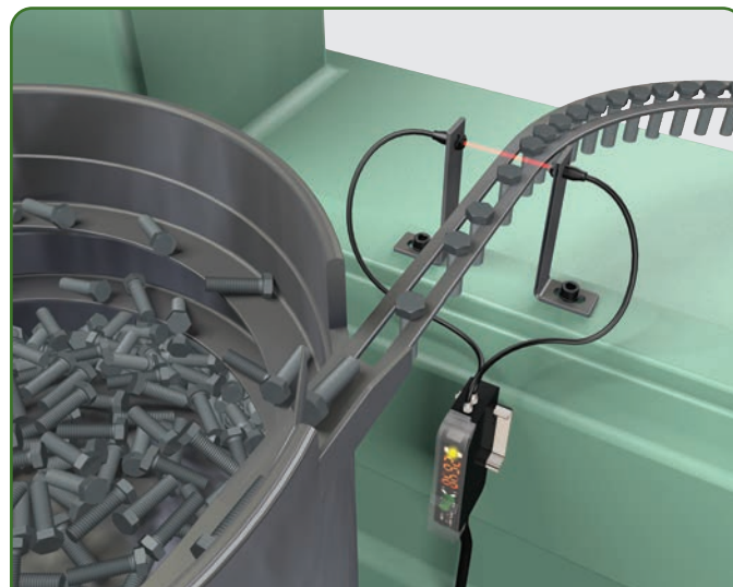
Detección de piezas pequeñas - La fibra óptica 46DFA asegura el flujo continuo de piezas pequeñas que salen de un recipiente alimentador.
