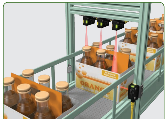
Inspección de embotellado - Cuando un 42JT LaserSight montado en el lateral del transportador detecta la caja de botellas, activa los tres VisiSights estándar de arriba para determinar si falta alguna botella.
