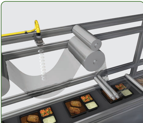
Detección de posición de cinta - El 873M ultrasónico comprueba la constante alimentación de la cinta a la vez que monitorea la tensión que presenta.
